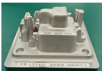
図1 樹脂射出成形用の試作金型
