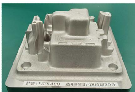
図 1 樹脂射出成形用の試作金型
