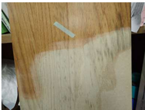
写真8 鉄汚染が疑われる試料（研磨済）
