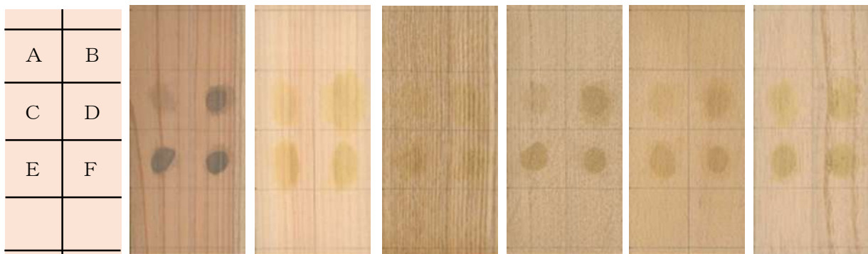
図2 変色再現実験結果（市販洗浄剤）
