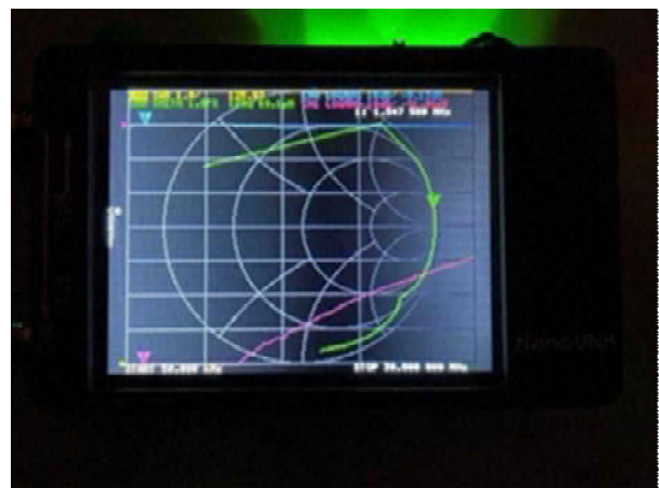
写真1 Nano VNAによる測定結果
