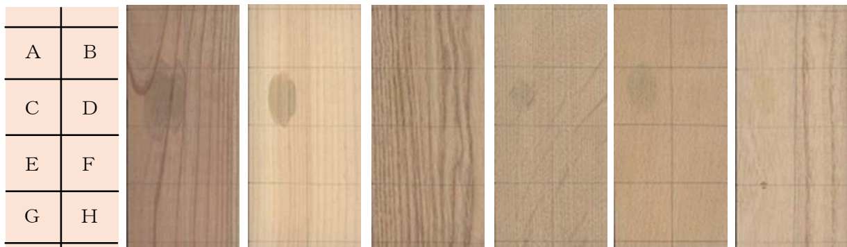
図1 変色再現実験結果（アルコール・消毒液）
