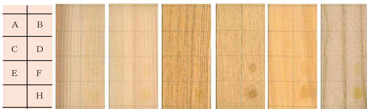
図4 変色再現実験結果（アルカリ性溶液（水酸化カルシウム水溶液））
