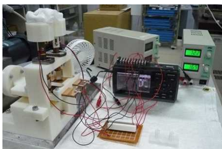
図2 試作した往復摺動負荷試験機の外観②
