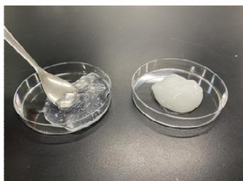
図1 (左から) 化学的製法及び機械的製法による微細化セルロース分散液
