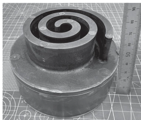
写真 スクロール翼の試作例
