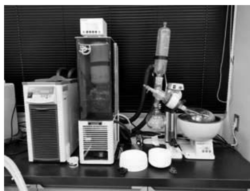
写真7 小型ロータリーエバポレータによる枝葉芳香蒸留水の試作
