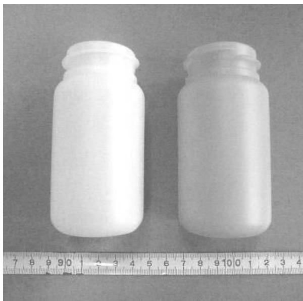
写真1 成形した小型ボトル (左: PE、右: PE/CNF 複合材)
