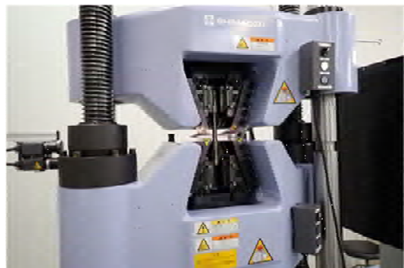
図2 前開き式のつかみ具 試験片を前から入れて装着できます
