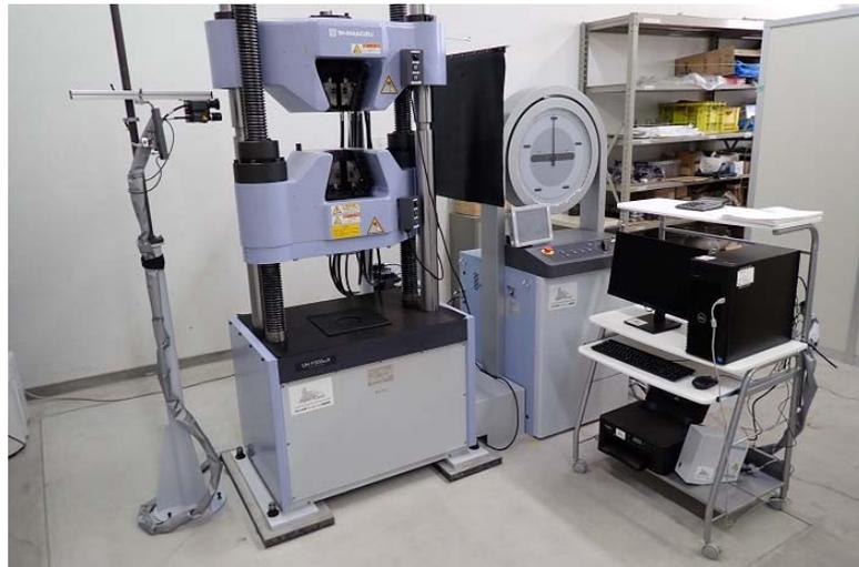
油圧式万能材料試験機本体
